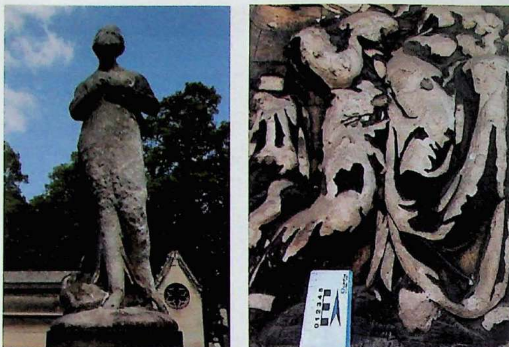
Figura 58: Desintegração de escultura, à esquerda. A direita, escultura com feição de pulverização, subtipo de desagregação de calcário que leva a perda progressiva das características e detalhes da obra.
