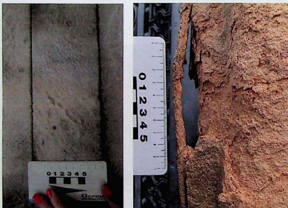
Figura 59: Sugaring, desagregação típica de mármore cristalinos brancos, à esquerda. Delaminação em calcário grosso que gera a desintegração da rocha, à direita.
