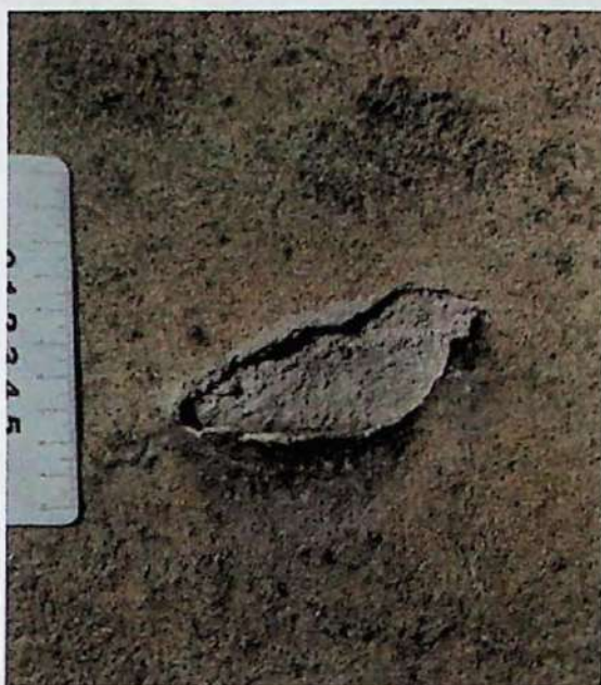
Figura 56: Desplacamento causado por bolha em calcário oolítico.
